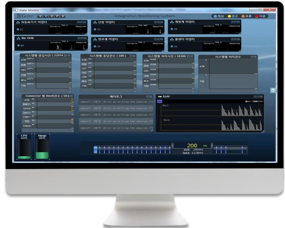
iGate 전문 관리자 또는 개발자가 아닌 시스템 상황실 모니터링 담당자를 위한 직관적이고 단순한 모니터링 화면을 제공합니다. 채널과 업무 시스템과의 연계 상태와 거래 처리 상태, 오류 발생 정보 등을 쉽게 인지할 수 있는 별도의 모니터링 화면을 제공합니다.
